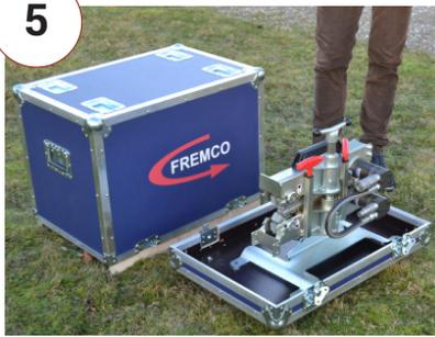
Retire la parte superior de la caja y colóquela sobre una superficie firme.
