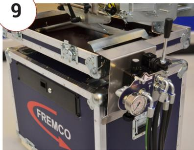
La válvula de control puede colgarse en el borde de la caja. Así podrá acceder a la válvula de control desde la parte operativa de la máquina.
