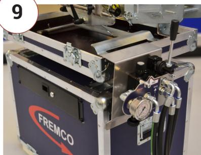
Das Regelventil kann am Rand der Box eingehängt werden. Sie können dann vom Betriebsteil der Maschine aus auf das Regelventil zugreifen.
