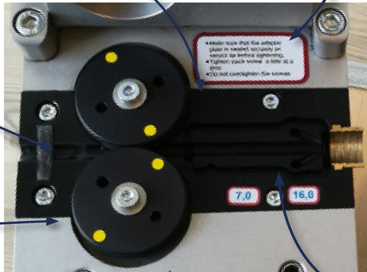
MicroFlow Dichtungen sind in unterschiedlichen Größen verfügbar für 4-16 mm Rohre AD und 0.8-6.5 mm Faser/Kabel..
