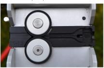
Las placas adaptadoras NanoFlow MAX y la rueda de acero MAX se aplican para microcables de 3,0-4,5 (mm)
