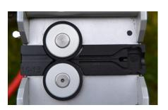
Pour les micro-câbles de 3,0 à 4,5 mm, les plaques d'adaptation NanoFlow MAX et la roue en acier MAX s'appliquent
